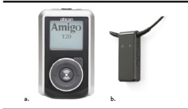
Figura 1. Transmisor de frecuencia modulada (FM) Oticon Amigo T20 (izquierda) y receptor FM Arc FM (derecha). Copyright 2013, por Oticon, Inc. Reproducido con permiso.
