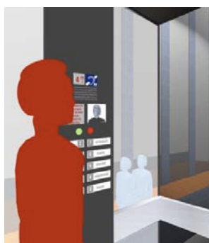
Figura 14: Ascensor dotado de paredes acristaladas, teléfono con bucle y videocámara
